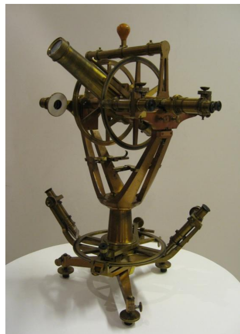
Repsold universalinstrumentet brukt under målingene i Finmark.
