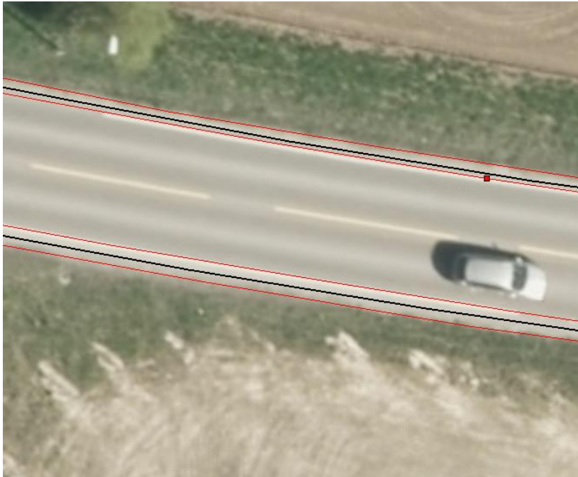
«Fasit» fra fotogrammetriseksjonen på Hønefoss (registrert i DFA). Vegdekkekant (svart) med Kjørbanekant (rød) på innsiden og Vegskulderkant (rød) på utsiden.
