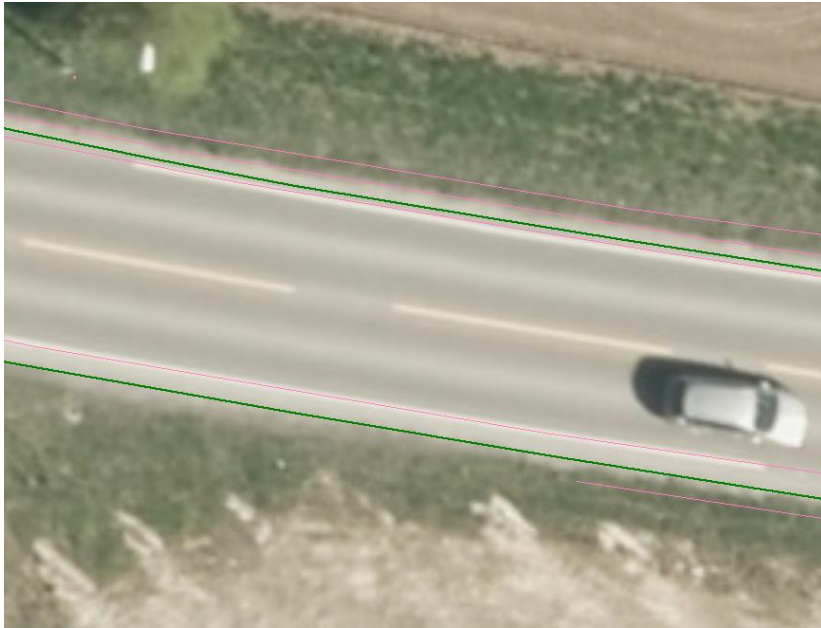
Firma B: Sammenfallende Vegdekkekant og Vegskulderkant i grønt nede, Kjørbanekant i rosa i vegflaten, oppe ser vi i rekkefølge (ned ifra og opp) Kjørebane kant, Vegdekkekant, Vegskulderkant og Åpenvegggrøft.
