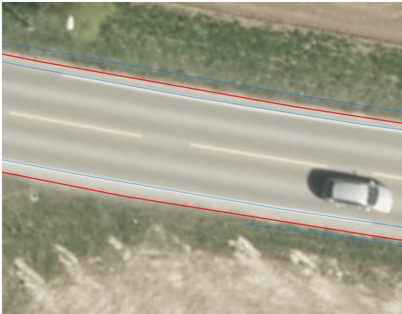
Firma C: Sammenfallende Vegdekkekant og Vegskulderkant på begge sider av vegen i rødt. Innenfor vises Kjørbanekant i blått og utenfor vegflaten Åpenvegggrøft i blått.
