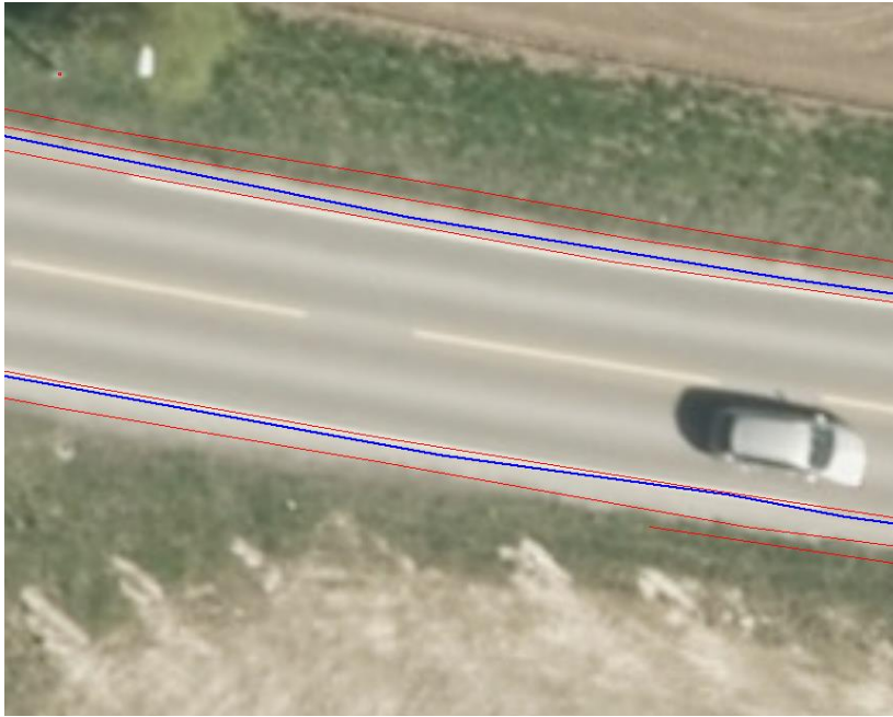
Firma D: Fra vegmidt og ut på begge sidene ser vi Kjørbanekant (rød), Vegdekkekant (blå), Vegskulderkant (rød) og sist Åpenveggrøft (rød).
