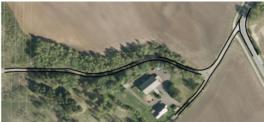
Landmålte fasitdata FKB-B - Vegsituasjon (svart), Takkant, AnnetGjerde og MurLoddrett (oransje), EL_belysningspunkt og Kumlokk (lilla). Nederste bilde viser landmålt grusveg.
