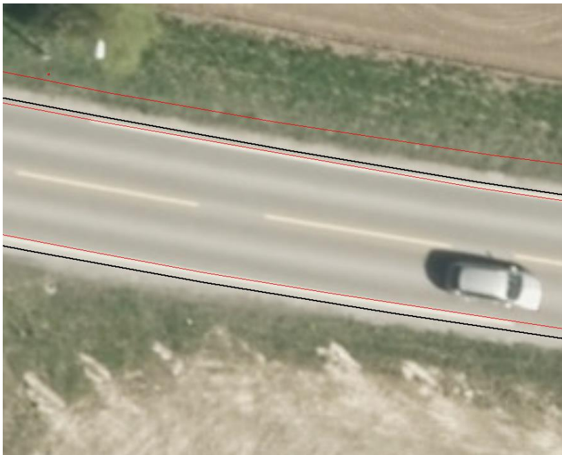
Firma E: Sammenfallende Vegdekkekant og Vegskulderkant på begge sidene (svart). Innenfor ses Kjørbanekant (rød) og lengst opp Åpenveggrøft (rød).
