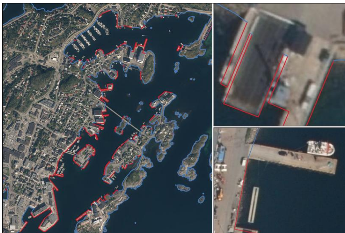
Figur 11: FKB-Kystkontur er bl.a. oppdelt i «kystkontur» og «kystkonturTekniskAnlegg». Det brukes ikke konsekvent og enhetlig i alle sammenhenger, og kan derfor fremstå svært oppstykket i enkelte områder.
