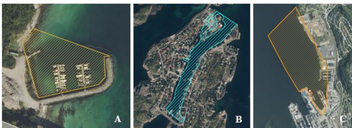
Figur 10: Oversikt over akvatiske deler av havn fra forskjellige datakilder – fra analyser for å finne bukter (A), fra Vannforekomster datasett (B) og trafikkareal planlagt i Havnedataprojekt (C).
