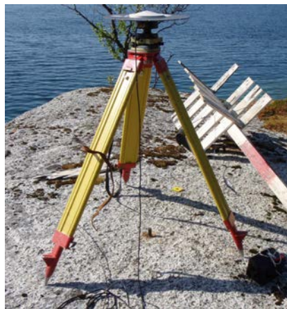
Figur 4.7: Oppstilling av GNSS-antenne på et landsnettpunkt.
