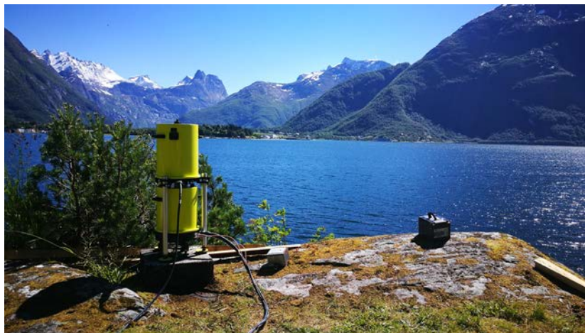
Figur 4.16: Måling av tyngde med absoluttgravimeteret A10.
