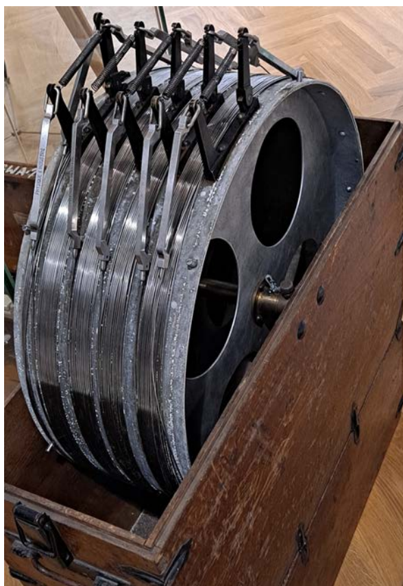
Figur F.13: Jæderins basisapparat, utstilt på det tekniske universitetet i Warszawa. Eget foto.
