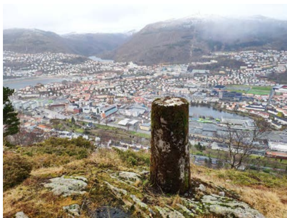
Figur F.17: Betongsøyle i punktet Løvstak S. Eget foto.
