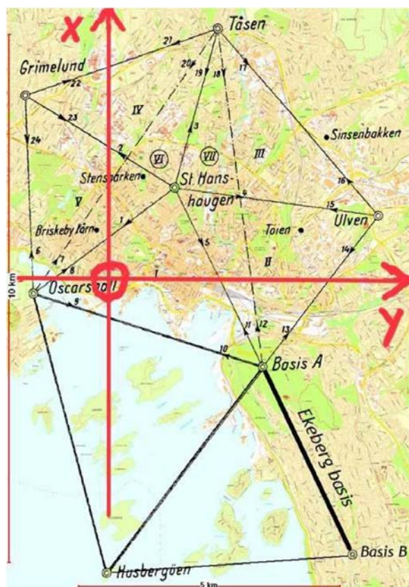
Figur G.1: Figuren viser etableringen av Oslo lokal grunnriss med 1. ordenspunkter (femkanten), tilknytning til landsnett/Ekeberg basis og realisering av plane koordinater ut fra Oslo Observatorium med meridianen som x-akse
