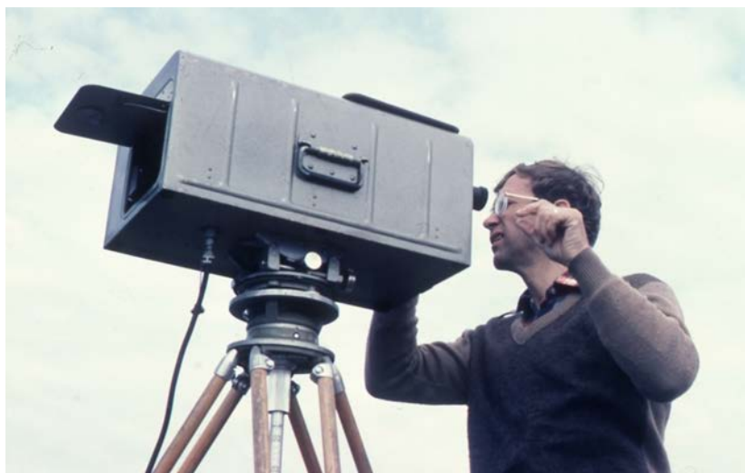
Figur 4.3: Geodet Lars Bockmann måler med lasergeodimeter ca. 1980.
