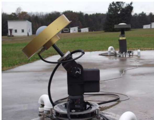
Figur 3.4: Antennekalibrering (foto: NOAA).
